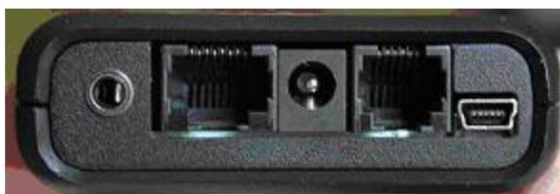
3.5mm相機 控制插孔 導星CCD 連接槽 12V 電源孔 赤道儀 連接槽 (ST4形式) USB
